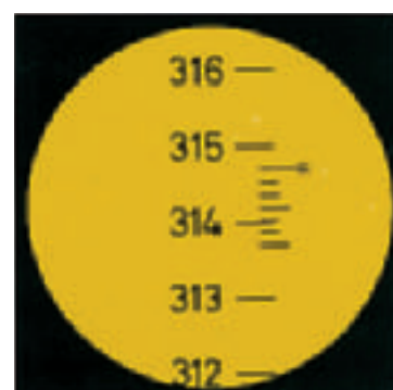
Lectura del círculo horizontal con el NAK2: (360°) 314°42'
